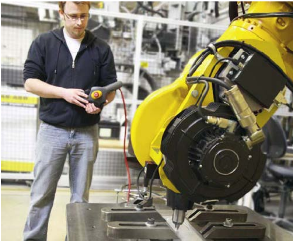
Slika 1. Testiranje FSW postupka uz pomoć Rosio™ Friction Stir Welding robota [1]
